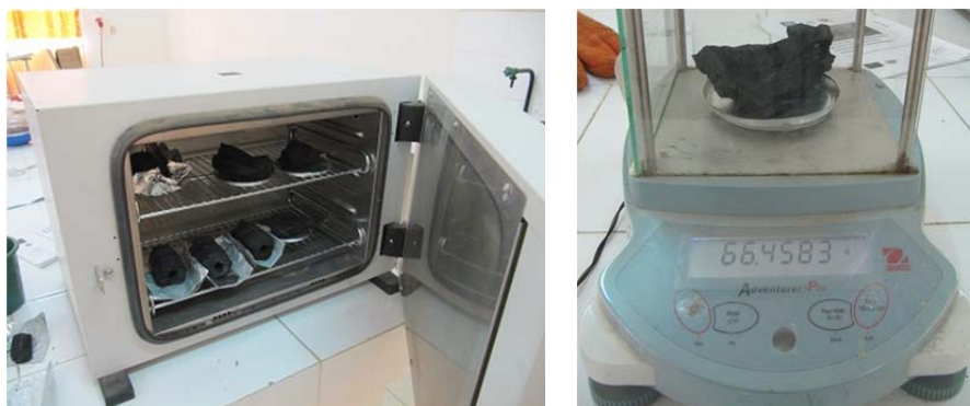
3. Étuve ventilé et balance utilisée à l'Iset pour mesurer l'humidité
