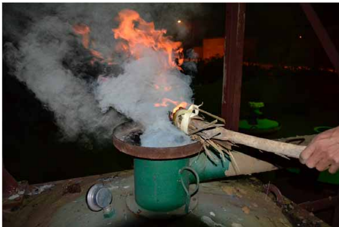
46. Combustion des gaz sortants d'un pot avec du Typha sec enflammé
