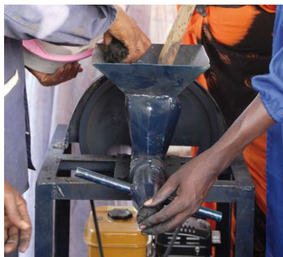
Briquetage du mélange dans la presse
