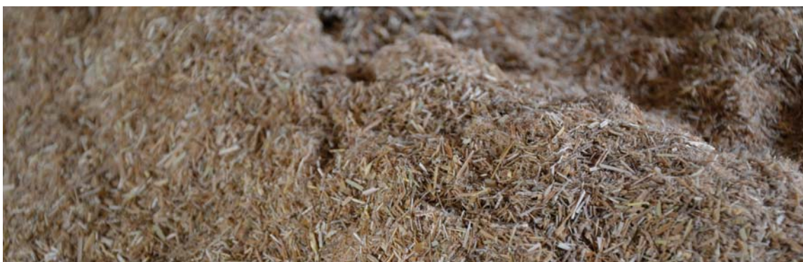
Typha sec broyé avant l'extrusion
