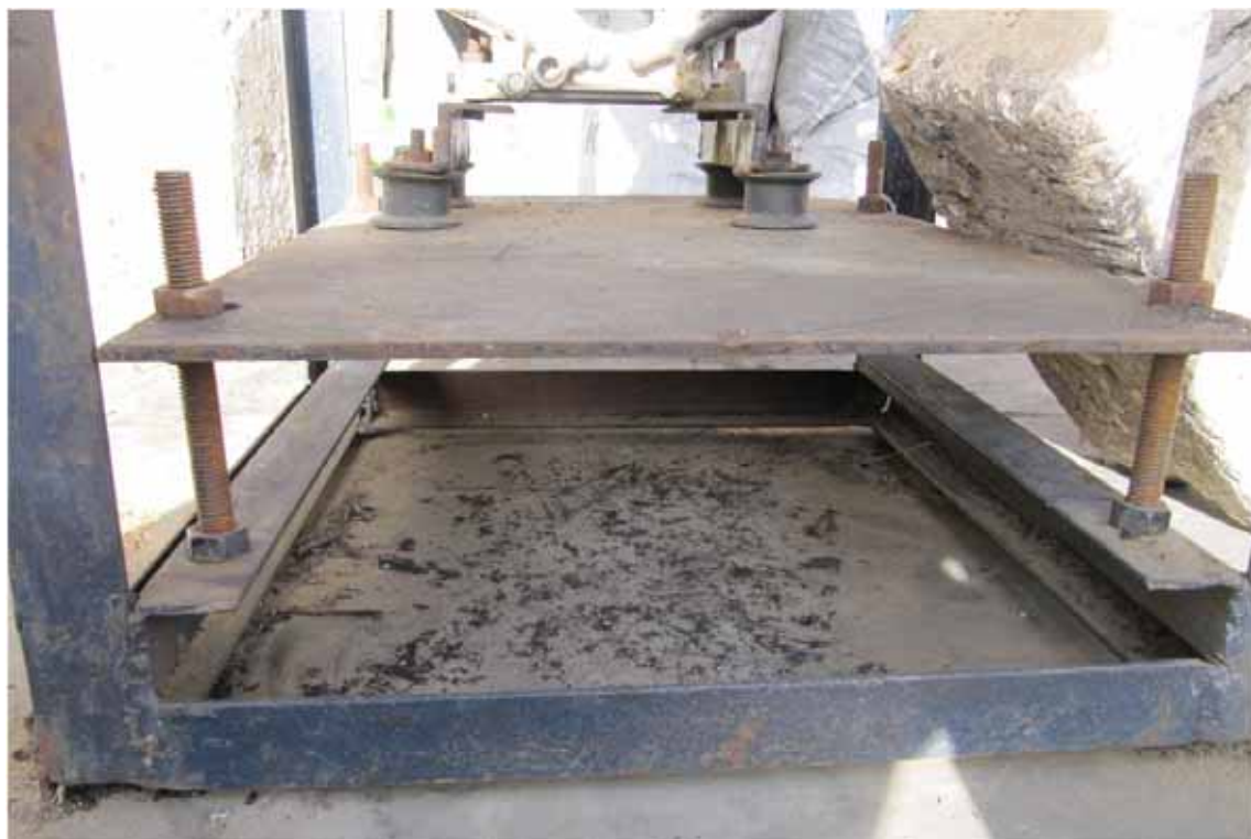
35. Plaque support moteur maintenue par les tiges filetés
