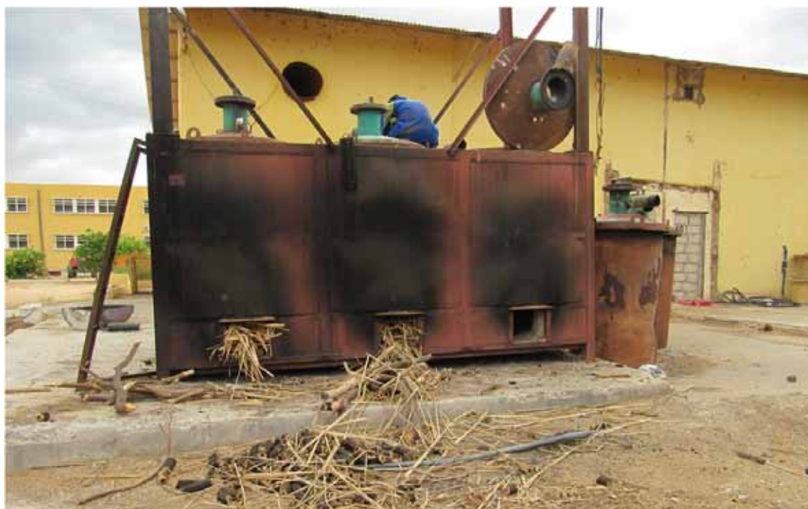
43. Vue du carbonisateur « 3 pots » du côté des foyers de combustion avant l'allumage
