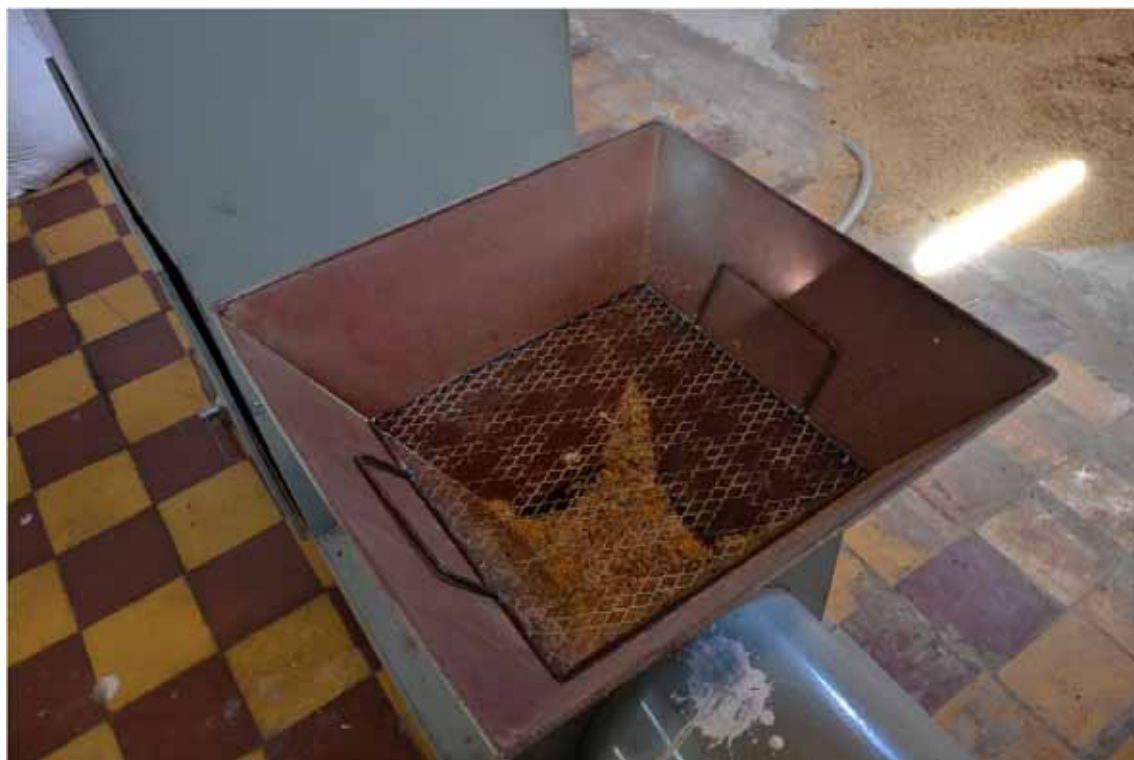
23. Trémie d'alimentation de l'extrudeuse protégée contre l'intrusion des mains des opérateurs
