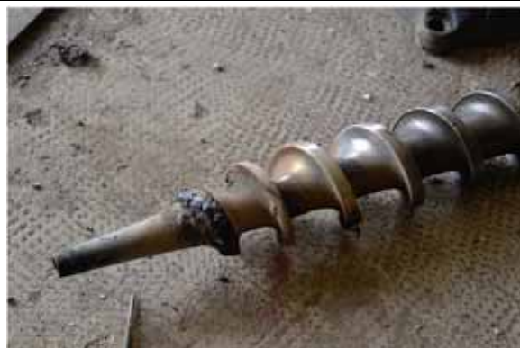
33 : Rechargement par la soudure
