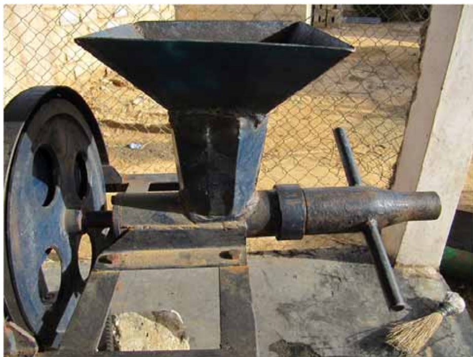
34. Vue extérieur de la partie haute de la presse à extrusion
