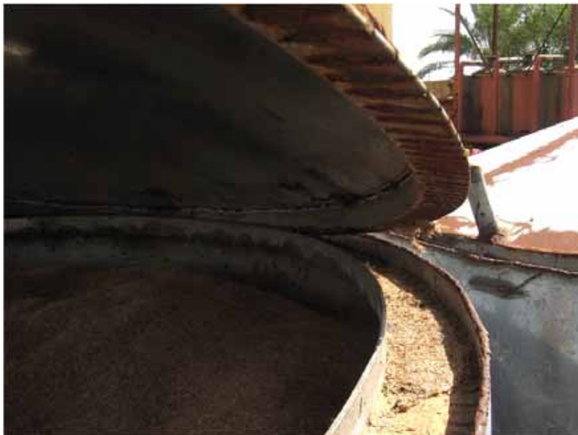
235. Carbonisateur « 3 fûts » ouvert avec le couvercle fini et la goutlotte
