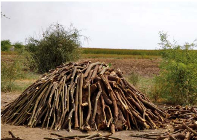
Meule traditionnelle de production de charbon de bois à 15 kilomètres à l'ouest de Rosso
