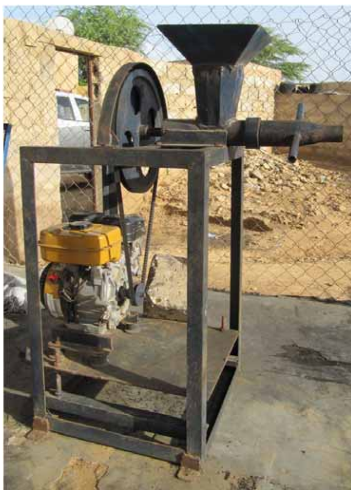
28. Presse à extrusion motorisé de l'Iset de Rosso
