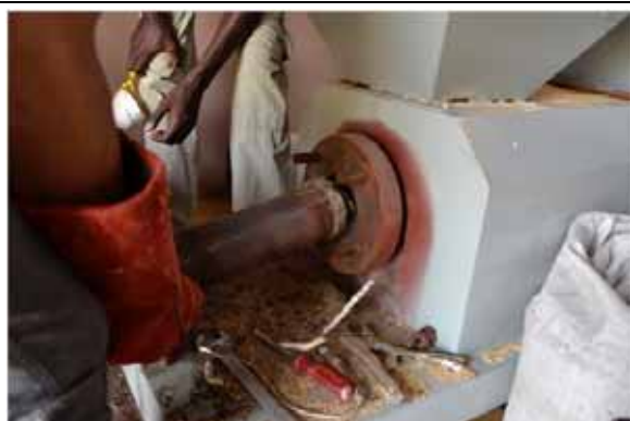
28 : Démontage de la filière
