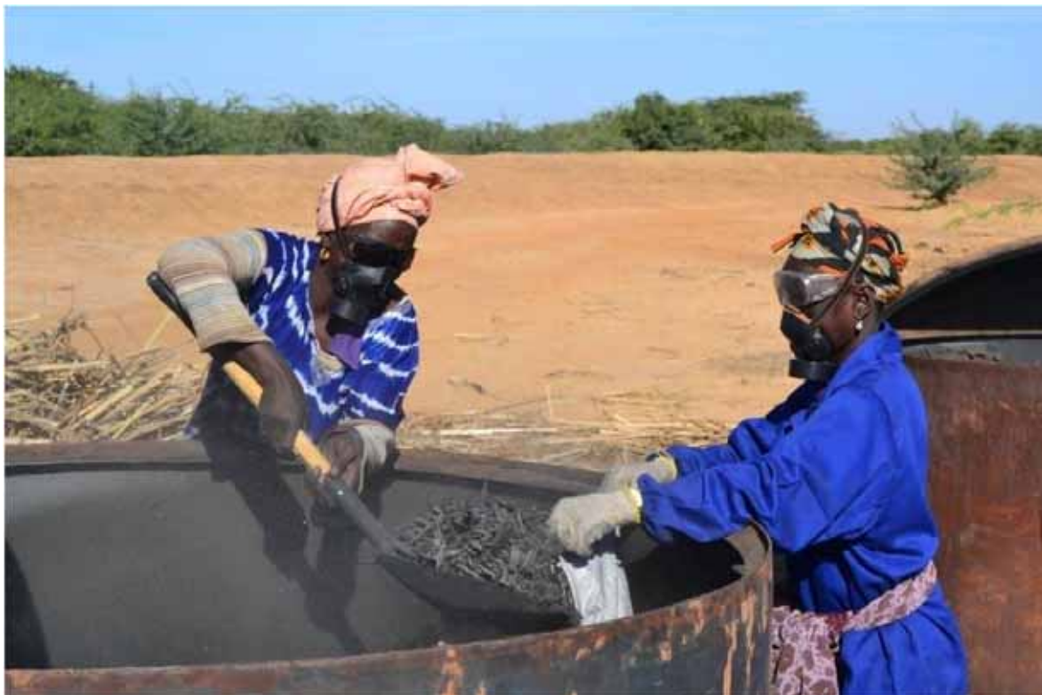
13. Défournement de la matière carbonisée avec la méthode de la pelle
