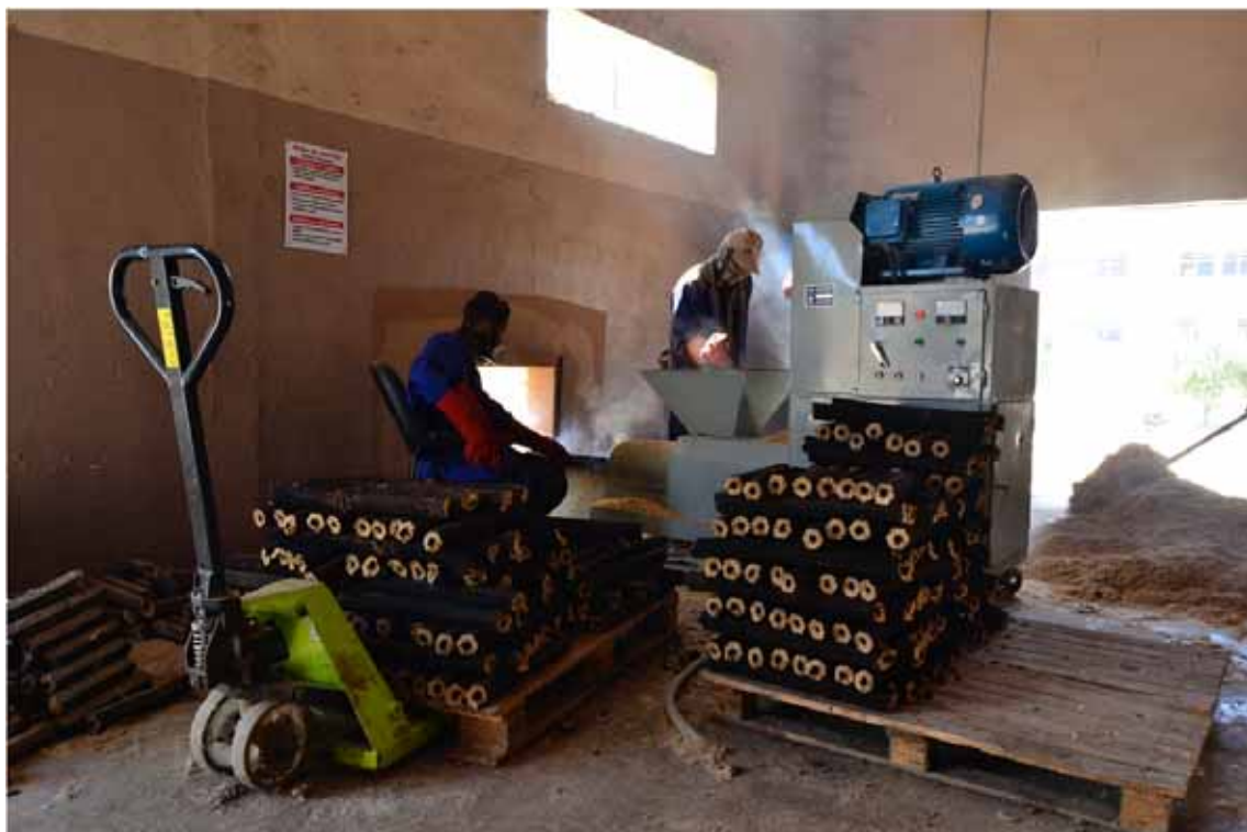
27 : Presse à extrusion - Vue globale
