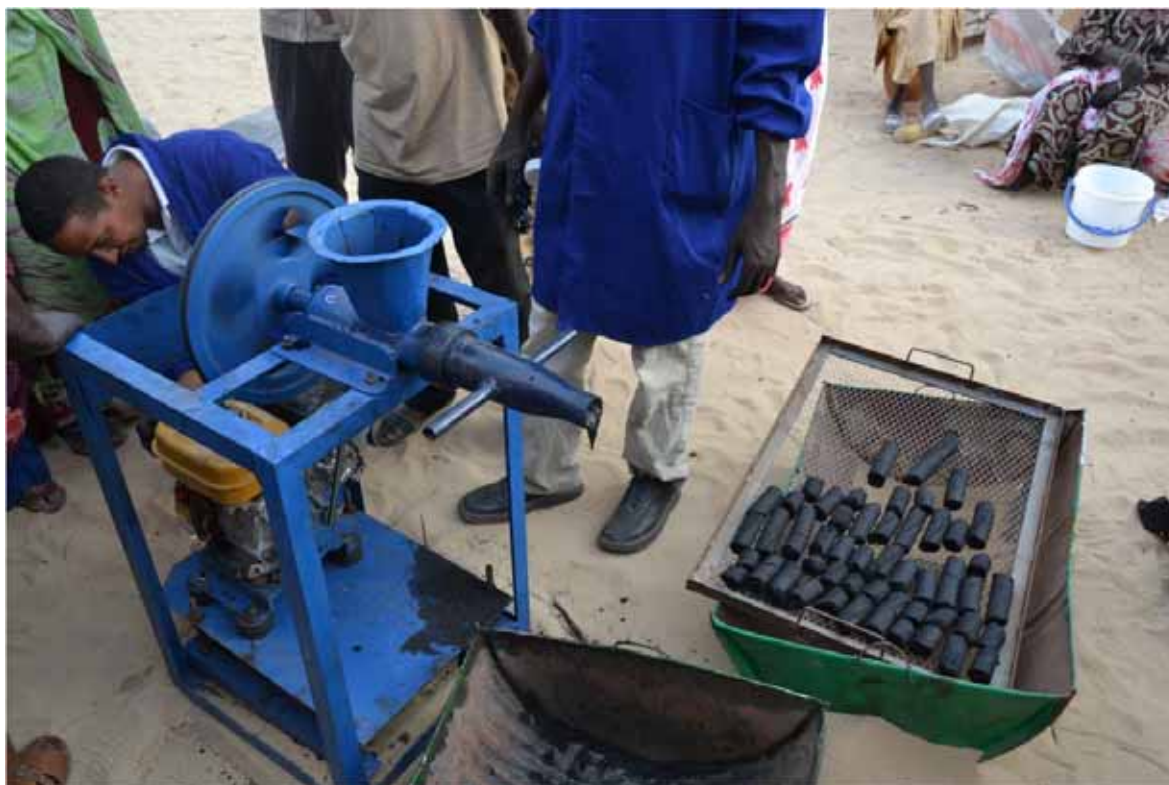
17. Presse à charbon avec moteur thermique essence
