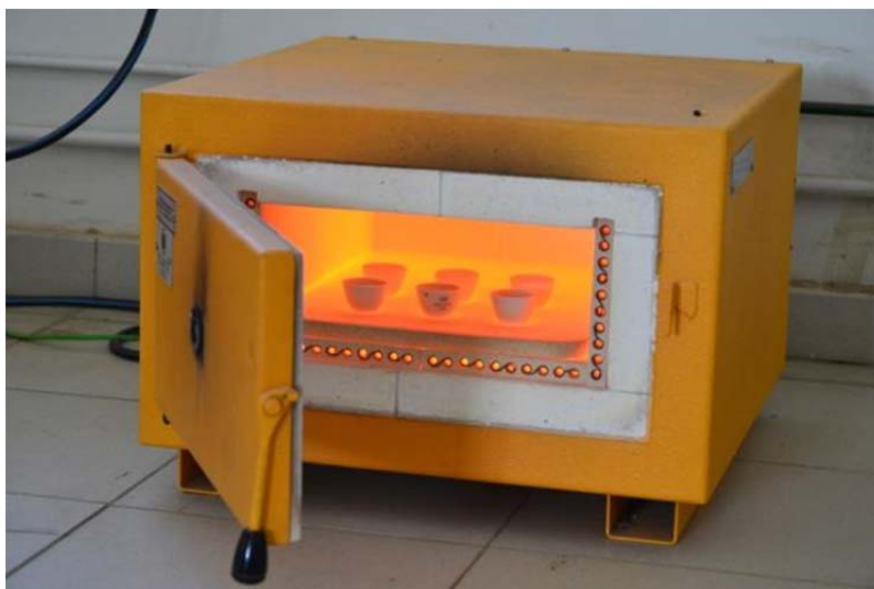
7. Four à moufle avec ses creusets à l'Iset
