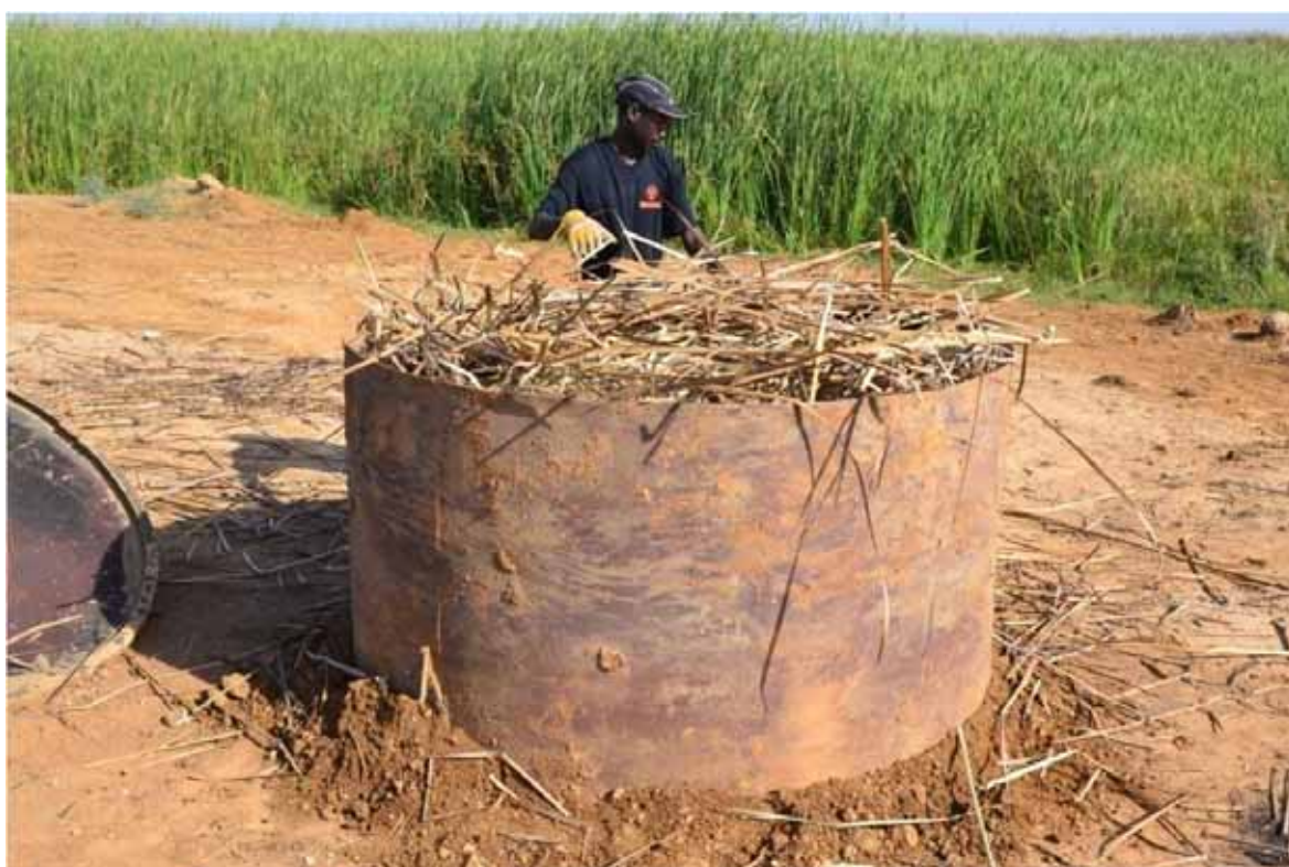
7. Remplissage du carbonisateur et fermeture de la base du carbonisateur
