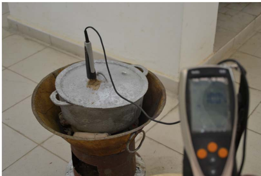
8. Test d'ébullition de l'eau avec un foyer malgache et du charbon de Typha
