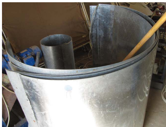
Tôles en acier galvanisé qui composent le carbonisateur
