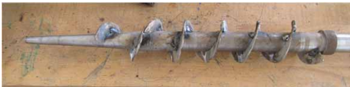
31. Partie hélicoïdale de la vis à extrusion
