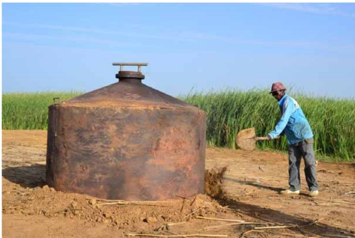
11. Fermeture des événements et pose du chapeau
