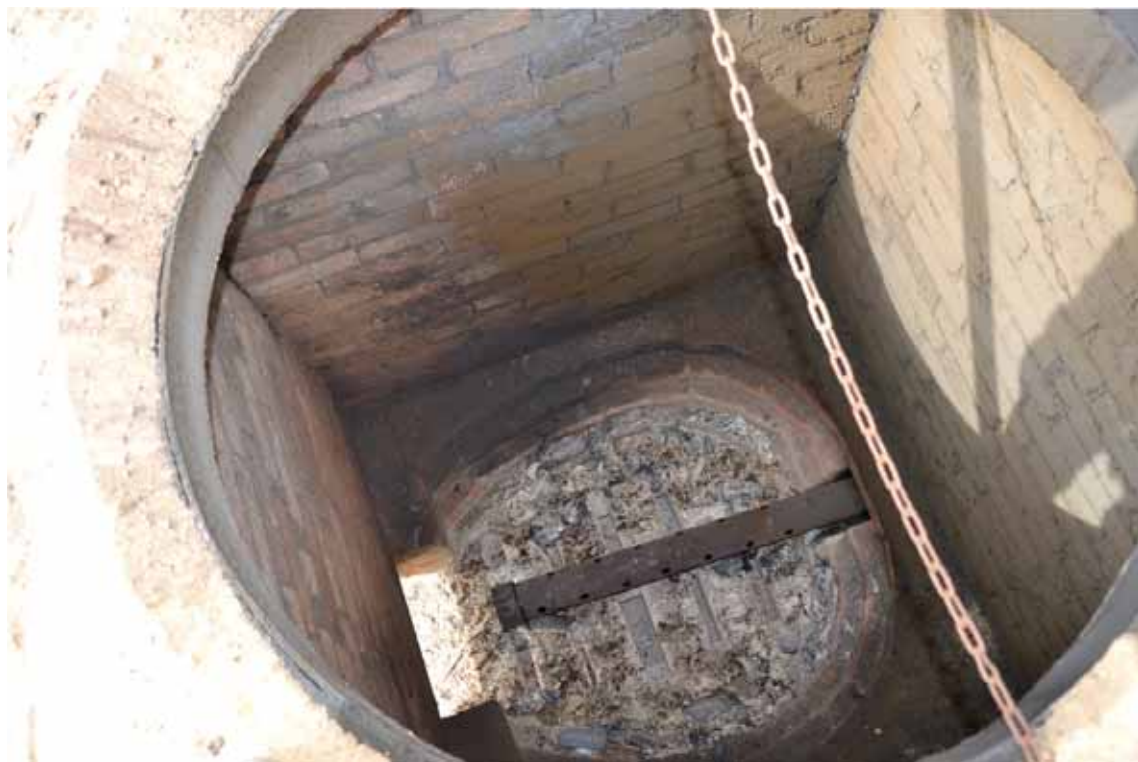
Figure 40 : Intérieur du four dans lequel le pot est glissé. Au fond, le tuyau réinjectant les gaz de pyrolyse sous le pot
