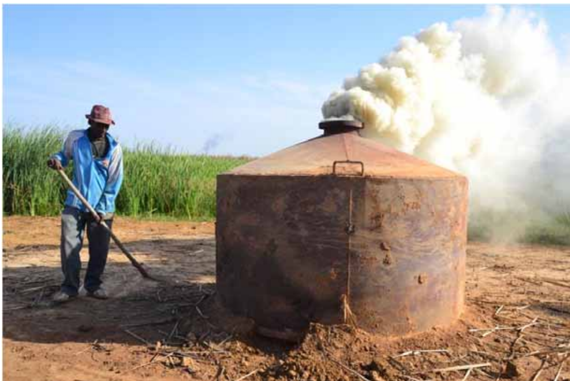
10. Contrôle de la carbonisation et déplacements des événements
