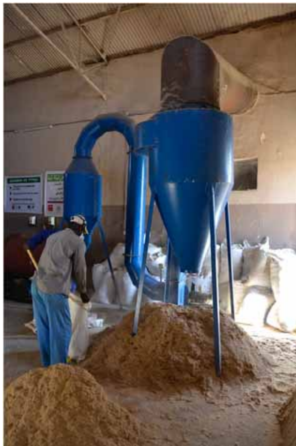
17 : Sortie du séchoir et récupération du Typha broyé séché
