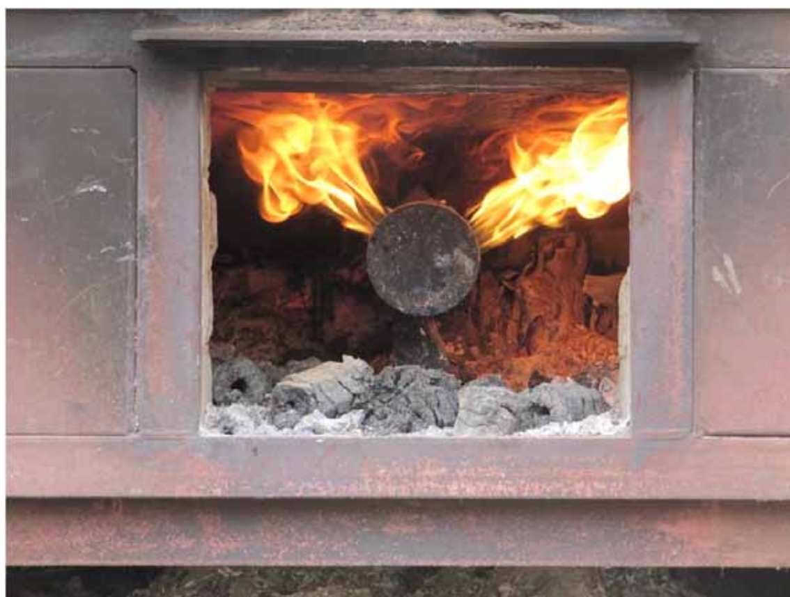
49. Carbonisation auto-entretenue grâce à la combustion des gaz de pyrolyse 12 heures après le début de la carbonisation
