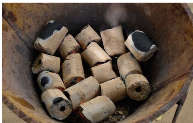
Combustion du charbon de Typha
