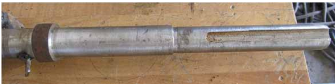
32. Partie arrière de l'arbre qui permet d'assurer le mouvement
